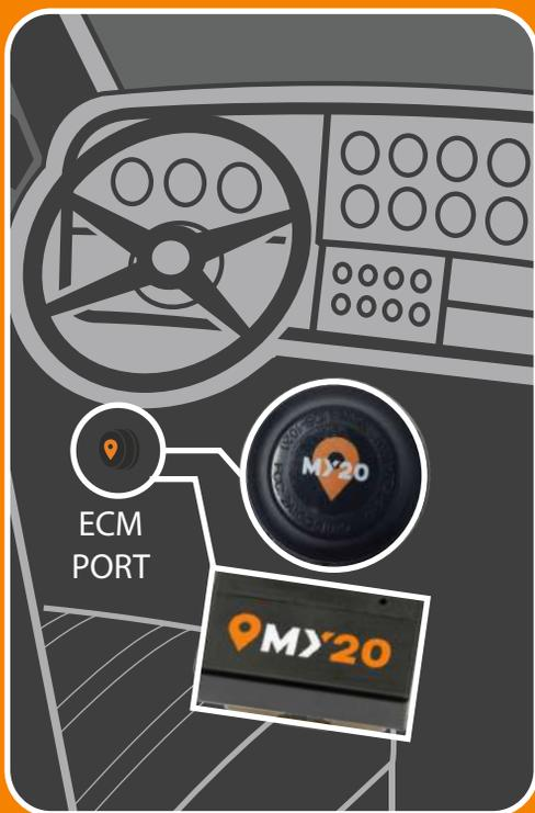
Para instalar MY20 ELD, haga coincidir la configuración del pin del ECM en el parte posterior del ELD a su ECM conector (9 pines u OBDII). Tenga Cuidado para alinear el "pasador" central que tiene una anura como una "llave", empuje el dispositivo para que se asient completamente, y después gire el anillo de bloqueo exterior en sentido de las agujas de reloj (hacia la derecha) un 1/8 para asegurarlo en su sitio.
